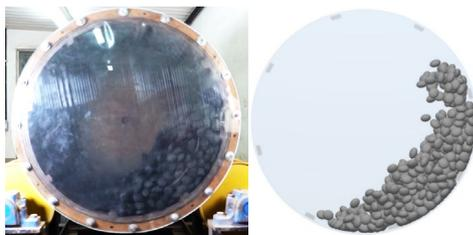
**Figura 2** – Ensaio de tamboramento à esquerda e simulação à direita.
