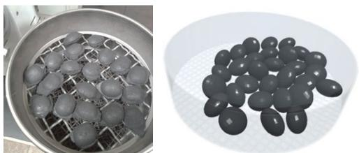
**Figura 1** – Briquetes dispostos na série de peneiras, à esquerda e simulação DEM do movimento dos briquetes na peneira de 19 mm, à direita.
