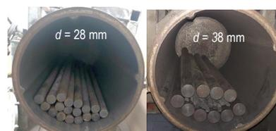
**Figura 1** – Vista frontal do moinho de barras com 0,3 m x 0,6 m de comprimento utilizado nos ensaios em batelada
