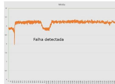
**Figura 3** –Mapeamento da espessura de parede do tubo (Falha detectada na região de depressão do gráfico).
