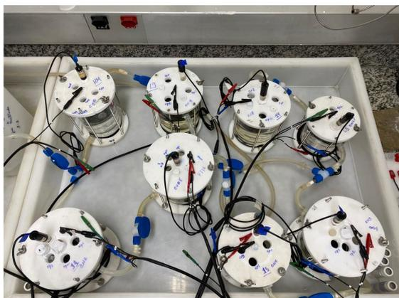
Figura 2 – Células eletroquímicas usadas nos ensaios
