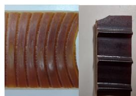
**Figura 1** – Amostras de PA11 oriundas de campos de petróleo: FS1 à esquerda e FS2 à direita.
