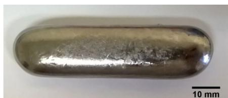
**Figura 2** – Lingote da amostra (Ti-29Nb-2Mo-Zr) após a fusão.
