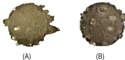
**Figura 1** – Imagens dos depósitos obtidos por eletrorecuperação. Depósito sem Mn<sup>2+</sup> na solução (A), depósito com Mn<sup>2+</sup> (B).
