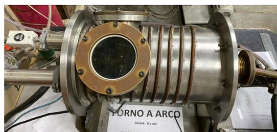
**Figura 1** – Forno de fusão a arco da EEL – USP utilizado na fusão dos lingotes
