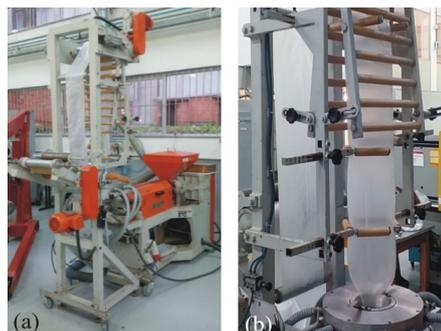
Figura 1 - (a) extrusora SEIBT ES-35, (b) processamento dos filmes termoplásticos
