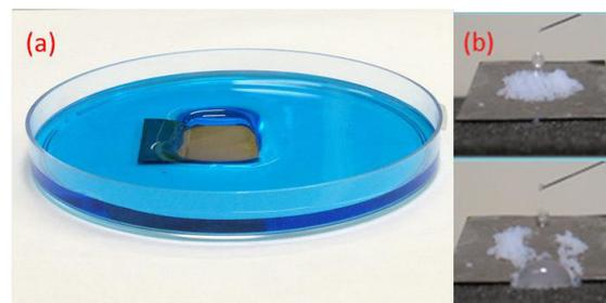
Figura 2 – (a) Superfície metálica superhidrofóbica semi-imersa em água e (b) efeito autolimpante.
