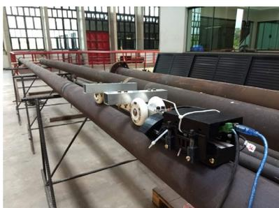
Figura 2 – Ilustração do sistema de inspeção
