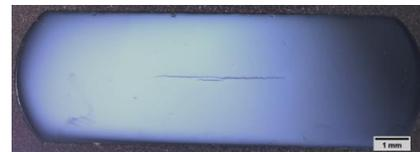
Figura 3 – Corpo de prova após 7 dias de imersão em solução contendo  $H_2S$ .
