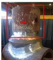
Figura 1 – Imagem do coletor de saída do superaquecedor de vapor com a marcação da posição de retirada dos corpos de prova.
