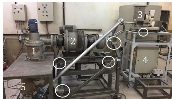
Figura 1 – Circuito de moagem: 1 – Classificador, 2 – Moinho, 3 – Alimentador vibratório, 4 – Painel de controle do alimentador, 5 – Câmera de poeira para coleta de produto. Os círculos indicam algumas das células de carga do sistema.
