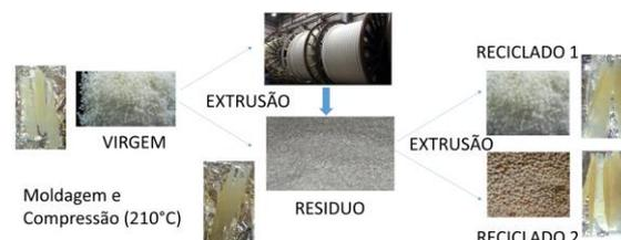
Figura 1 – Diagrama Esquemático das Amostras
