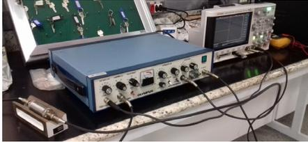
Figura 2 – Bancada experimental para ensaio ultrassônico.
