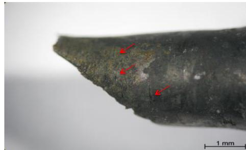
Figura 4 - Estereoscópica com aumento de 25X evidenciando presença de trincas secundárias no corpo de prova ensaiado com 50% fluido orgânico e 50% salmoura com H<sub>2</sub>S.
