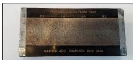
Figura 2 – Bloco de calibração usado na otimização.
