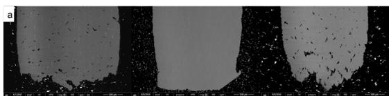
Figura 2 – Imagens de MEV retroespalhado das seções longitudinais das fraturas a (a) 650, (b) 850 e (c) 900°C, em aumento nominal de 60x.
