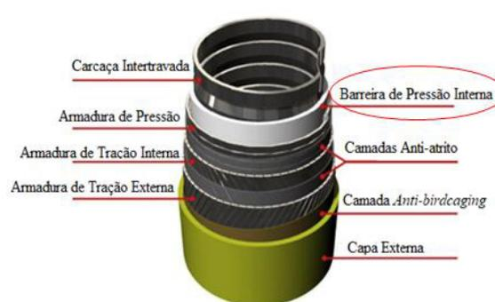
Figura 1: Estrutura de uma linha flexível [2].
