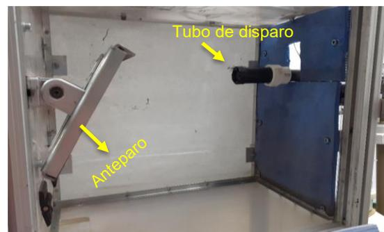
**Figura 1** – Equipamento utilizado para teste de impacto de alta velocidade.
