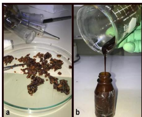
**Figura 2** – Síntese do policardanol utilizando-se 2% em massa de iniciador a partir do (a) cardanol envelhecido e a partir do (b) cardanol redestilado.
