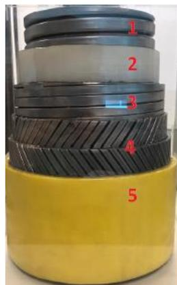
Figura 1 – Camadas de um tubo flexível.
