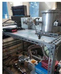
**Figura 1** – Reator PACVD desenvolvido no Laboratório de Engenharia de Superfícies,PEMM – COPPE-UFRJ
