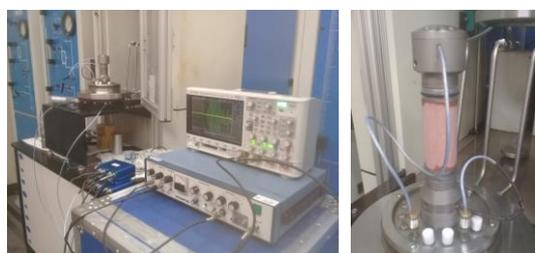
Figura 2 – Bancada experimental (esquerda) e montagem com amostra de arenito (direita).
