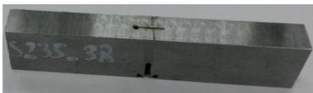
**Figura 4** – Fotografia do corpo de prova com *split* emulado mediante usinagem. Tomada de [10].
