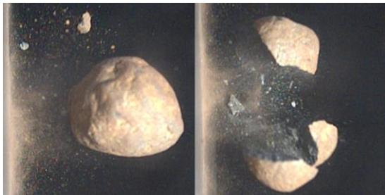
Figura 2 – Impacto da pelota a 17.5 m/s. À esquerda: quebra superficial e à direita: quebra volumétrica.
