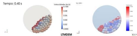
**Figura 3** - Simulação de moinho piloto. À esquerda, o código LTMDEM e, à direita, o software comercial EDEM.
