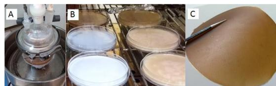
**Figura 1** – Etapas de gelatinização (A) e casting, respectivamente, dos filmes controle (TPS) (B) e Filme pronto com 5% de cacau (C).
